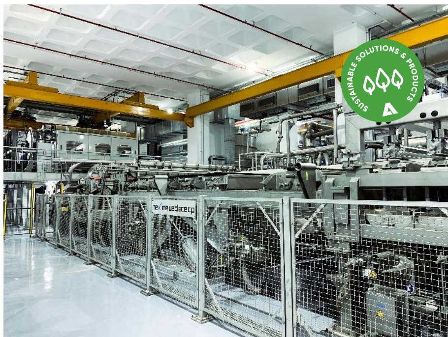
ANDRITZ neXline wetlace CP-Linie für die Produktion von Vliesstoff-Rollenware für biologisch abbaubare Feuchttücher bei Lotus Teknik Tekstil A.Ş., Türkei
